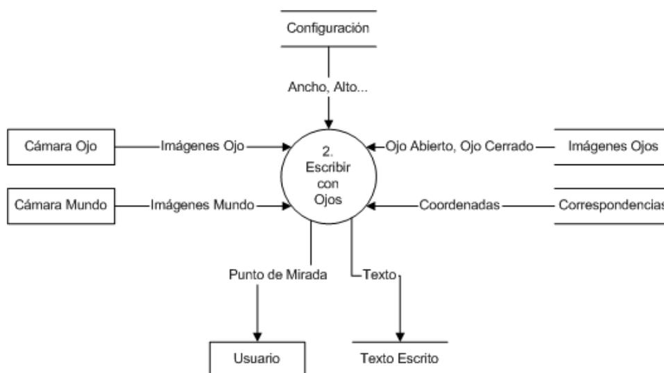
Diagrama de Flujo de Datos de infrared, aplicación para calcular el punto de mirada:
