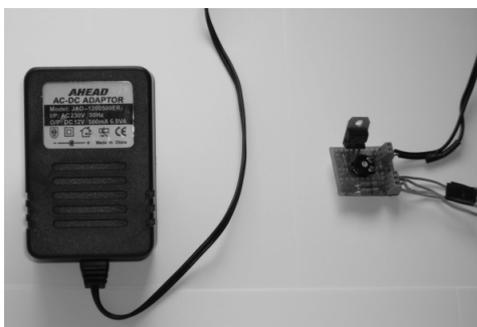
Figura 4.6: Transformador y circuito de alimentacion de LEDs utilizados
